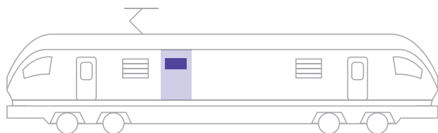
Poglądowe rozmieszczenie regulatora napięcia wzbudzenia generatora SAN-AVR w lokomotywie
