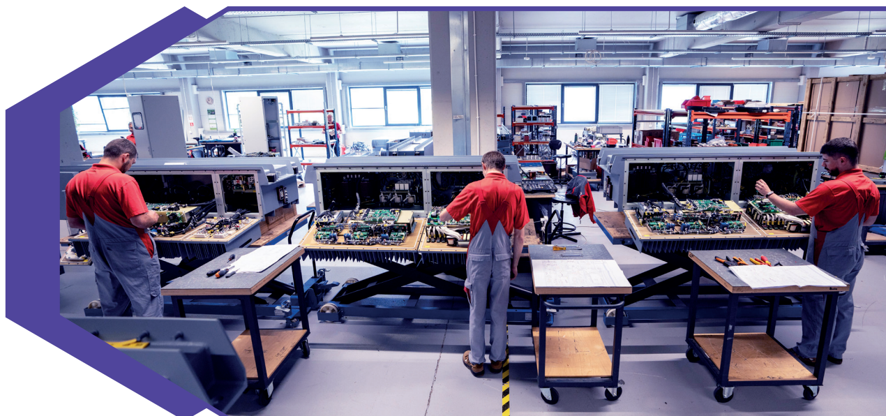
Montaż końcowy urządzeń trakcyjnych
