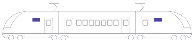
Poglądowe rozmieszczenie przetwornicy częstotliwości HPI 15T 2500/400 TR i prostownika trakcyjnego PD 450T 2500 TR w pojeździe elektrycznym
