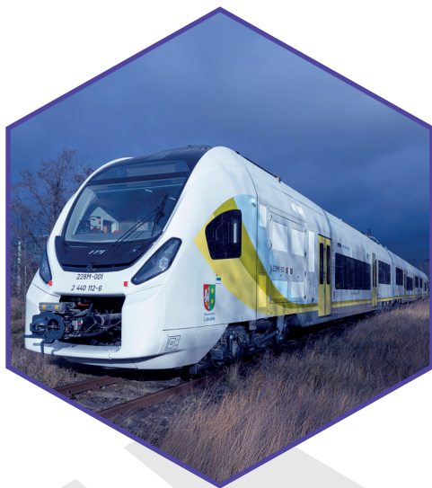
Pojazd hybrydowy typu 228M wyposażony w przetwornicę częstotliwości HPI 15T 2500/400 TR, prostownik trakcyjny PD 450T 2500 TR oraz SAN-AVR3
