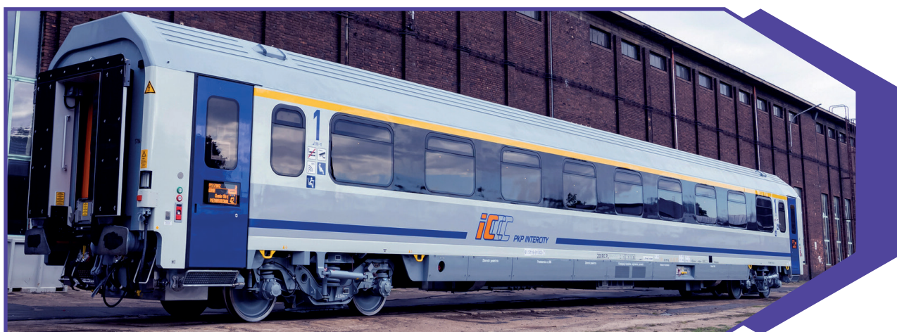
Wagon typu 178A-1 zasilany przez przetwornicę statyczną wielosystemową BFI 50T TRW
