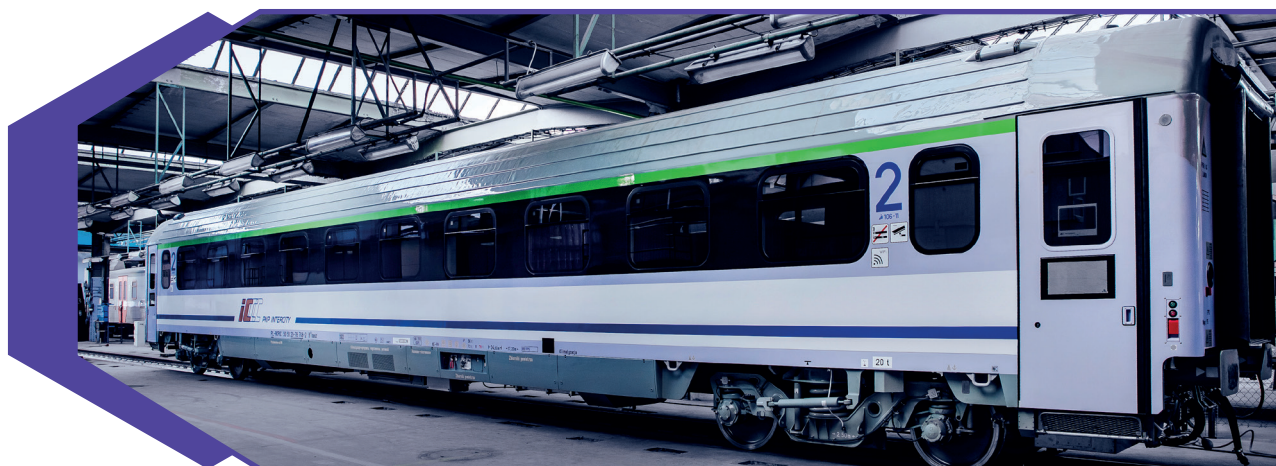
Wagon typu 174A zasilany przez przetwornicę statyczną jednosystemową BFI 50T TR
