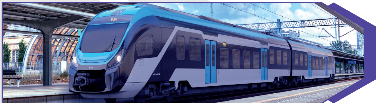
Pojazd hybrydowy typu 227M wyposażony w przetwornicę częstotliwości HPI 15T 2500/400 TR, prostownik trakcyjny PD 450T 2500 TR oraz SAN-AVR3
