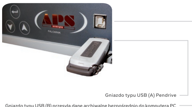
Gniazdo typu USB (B) przesyła dane archiwalne bezpośrednio do komputera PC
