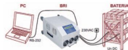
Rys. 6 Schemat działania opornicy BRI
